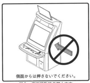
図5:床面移動時の禁止方向
