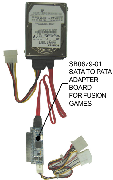
SCHEMA 6 - NOUVEAU DISQUE DUR SATA POUR FUSION MACHINES AVEC CARTES MERES ECS (VOIR SCHEMA 9 POUR CONNEXIONS)
