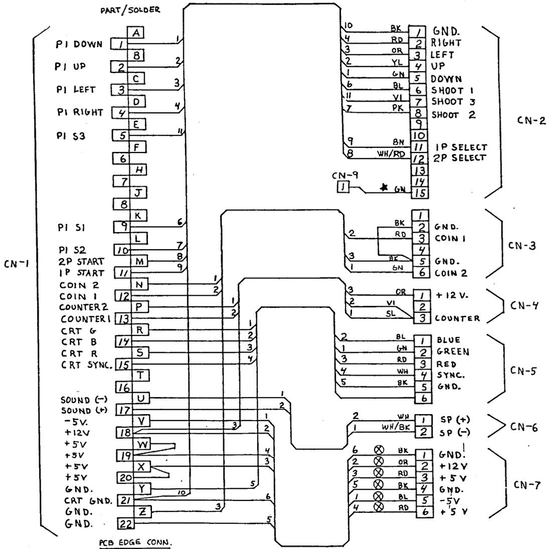
**B. Edge connector pin-out.**
